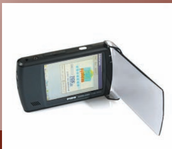
Palmare industriale TGS con sistema operativo Windows CE 5.0 e batteria da 2680mAh, display da 3.5 pollici TFT QVGA / 64K color
